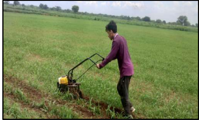
चित्र: सी.आई.आर.जी. शक्ति चालित निराई यंत्र का भारतीय चरागाह एवं चारा अनुसंधान संस्थान, झाँसी में ज्वार चारा फसल में परीक्षण
