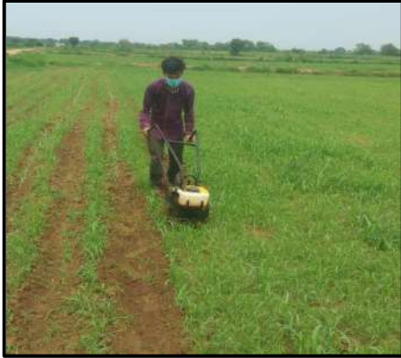
चित्र: सी.आई.आर.जी. शक्ति चालित निराई यंत्र का भारतीय चरागाह एवं चारा अनुसंधान संस्थान, झाँसी में ज्वार चारा फसल में परीक्षण
